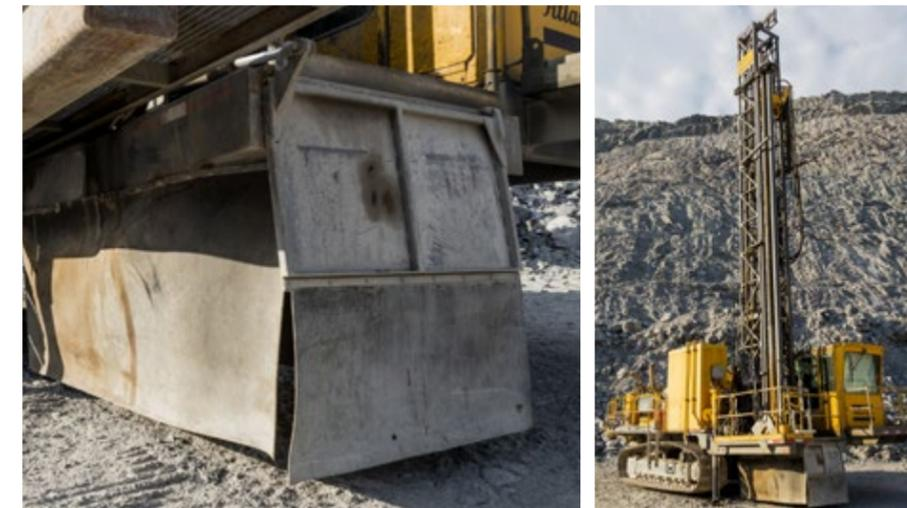
Exemple de mesure d'atténuation : nos foreuses de production sont munies de jupettes de caoutchouc et de réservoir à eau pour limiter la dispersion de la poussière lors de forage.
