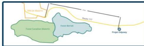
Il est prévu d'exploiter le Projet Odyssey au moyen de galeries souterraines à l'est de la mine Canadian Malartic. Le projet nécessitera, entre autres, l'aménagement d'un puits et d'une rampe pour accéder aux zones minéralisées jusqu'à une profondeur estimée de 2 000 mètres, ainsi qu'un nouvel accès à la route 117.
